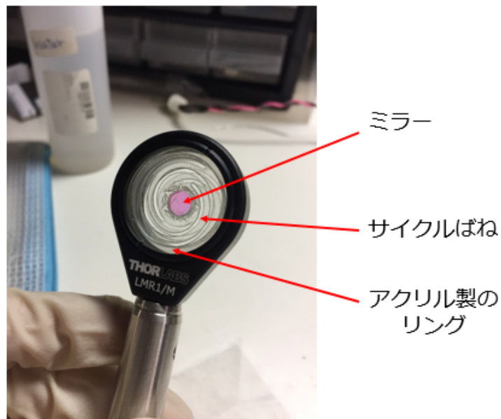
図4.11 懸架系の完成品
